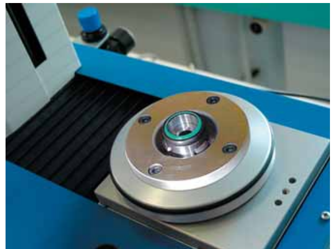
Unité de serrage pneumatique pour porte-outils HSK
