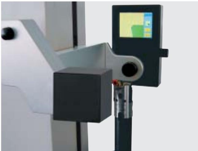
Le TM10-SMART optimise le pré réglage d'outils grâce à un projecteur de profil électronique. Le traitement d'image SMART remplace le projecteur de profil optique.
