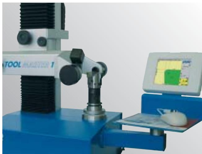
Le TM10-TCAM2 est le modèle d'entrée de gamme pour le pré réglage d'outils avec traitement d'image. C'est la combinaison intelligente entre une caméra digitale et un traitement d'images sur un écran couleur TFT 6.4"
