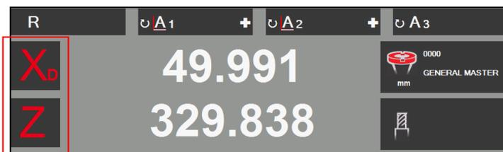
En cliquant sur X et Z une fenêtre contextuelle s'ouvre où les différents « modes de mesure des axes » peuvent être sélectionnés.
