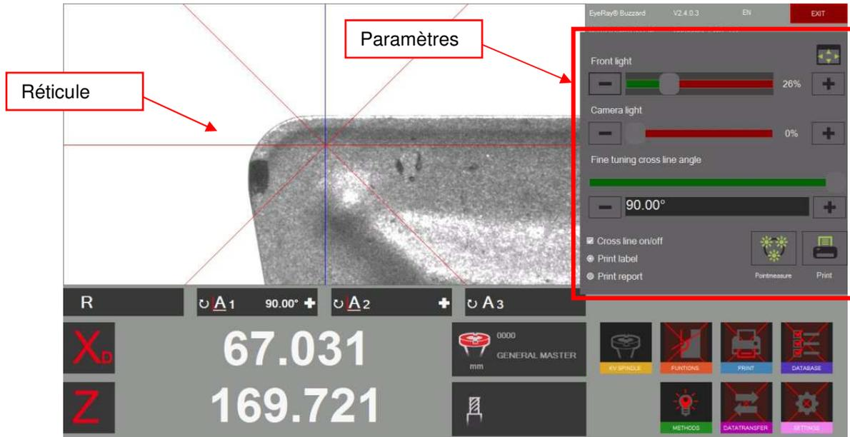
Cliquer avec le bouton gauche de la souris sur le réticule pour changer sa position. Les cassures ou défauts de l'arête de coupe peuvent alors être mesurés.
