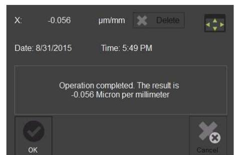
Dès que la procédure de correction du parallélisme est terminée, le système va demander le calibrage de l'appareil.
