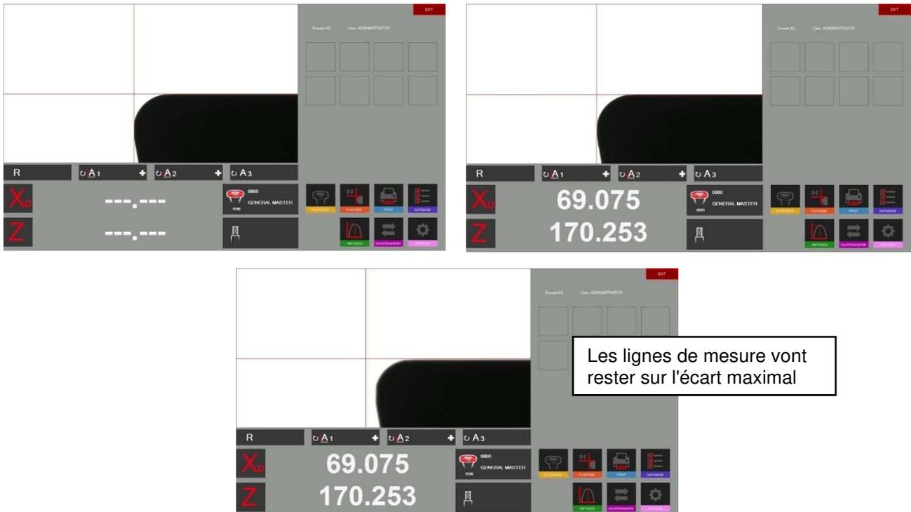
Si l'outil est sorti du champ de la caméra, le système va exécuter une réinitialisation en fonction des réglages de minuterie dans les paramètres (Chapitre 4.5.5/Paramètres/Indice options).
